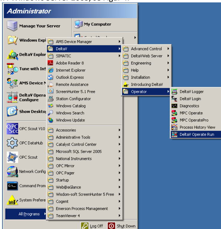
Figur 4 Oppstart av DeltaV Operate Run fra startmenyen i Windows Server 2003.
