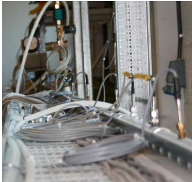
Figur 1-4 Seksjon av UBD-modellen til høyre i bildet, rør med påmonterte PT-100-elementer og reguleringsventil.
