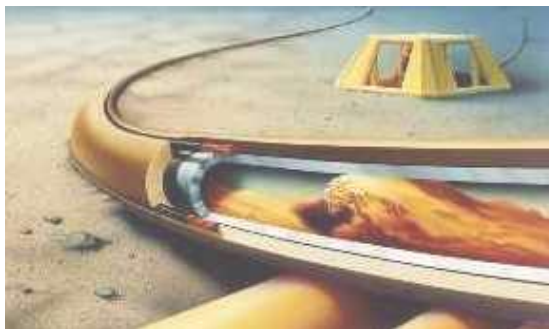
Figur 4-2 Tverrsnitt av strømningsrør med slugging.
