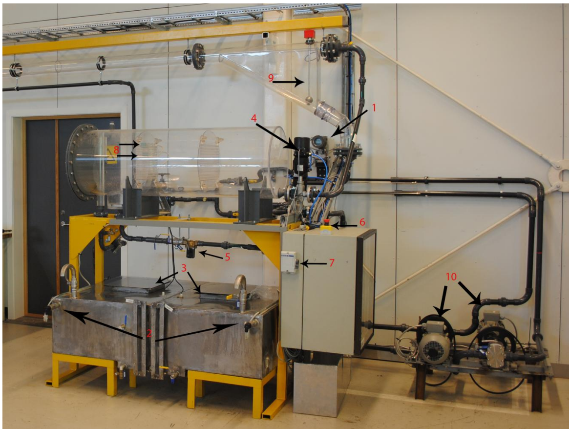
Figur 8-4 Oversiktsbilde av flerfaserigg med instrumenter, aktuatorer og brytere med punkter til forklaring
