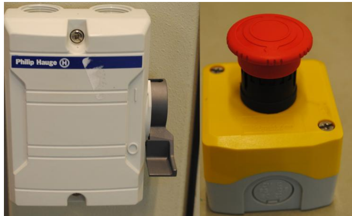
Figur 10-4 Hovedstrømsbryter og nødstop på flerfaseriggen
