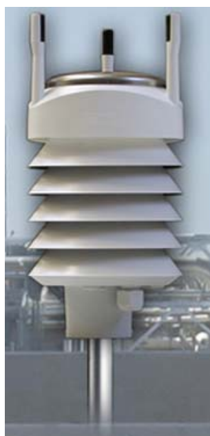
Figur 4-1 Orion 420 værstasjon for måling av metrologiske data [22].
