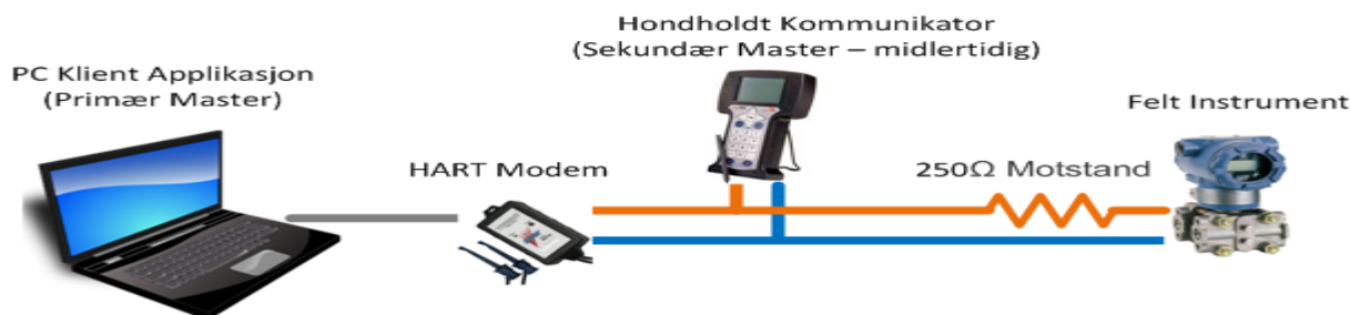
Figur 3-2 Master/slave i henhold til HART-protokoll.
